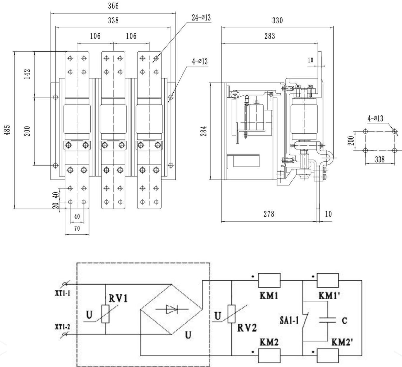
Вакуумный контактор KB50 1600A/1600-2000V
